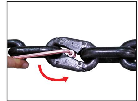
Travar o pino realizando um giro de 90° (¼ de volta) com uma chave allen.
