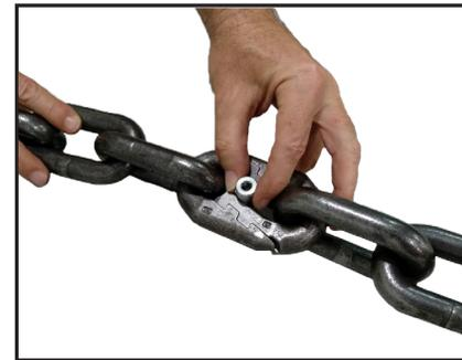
Inserir o pino na emenda para travar a montagem.
